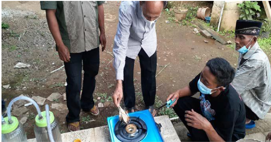
Gambar 3.3. Kompor nyala setelah melalui pemurni biogas
